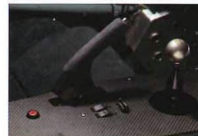
センターコンソールも難燃性基準をクリアしたカーボンで製作し、そこにパワーウィンドウスイッチをセット。シフトノブはチタン製のNSXタイプR純正品を使用している。
