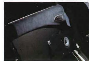
ダッシュパネルは表面だけではなく、サイド部も含めてアルカンターラで仕上げていて、助手席エアバッグの動作には問題がない。ドア内張りも難燃性のカーボンで仕上げています。
