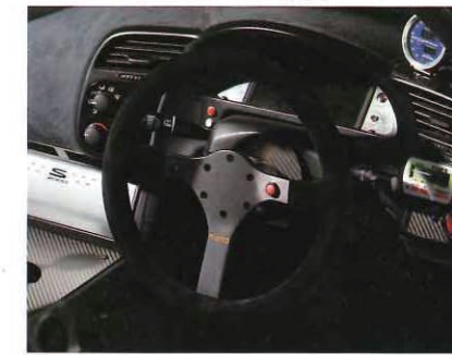
モモ製のステアリングはバックスキンを握る。ボスはアルミ削り出しで衝撃吸収基準クリアのASMオリジナル品。ステア全体とグリップ部、ボスも含めて赤外線測定によってセンター出しをしてあるため、操作感はバツグン。
