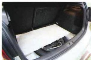
↓フロア用吸音材は、ミクロの微孔がノイズ等の振動エネルギーを吸収する。今回はトランクのフロアに敷き詰めた
