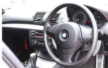
ステアリングの後方に見えるのがアルダックスからリリースされたパドルシフト。右側がシフトアップ、左側がシフトダウン。高速走行時などステアリングから手を離さずシフトできるので便利なアイテムだ。
