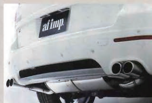
↑オールステンレス製となるオリジナルマフラー。軽量で、左右デュアル出しとなるテールが美しい。スポイラーインサートとのコンビネーションもイイ感じだ
