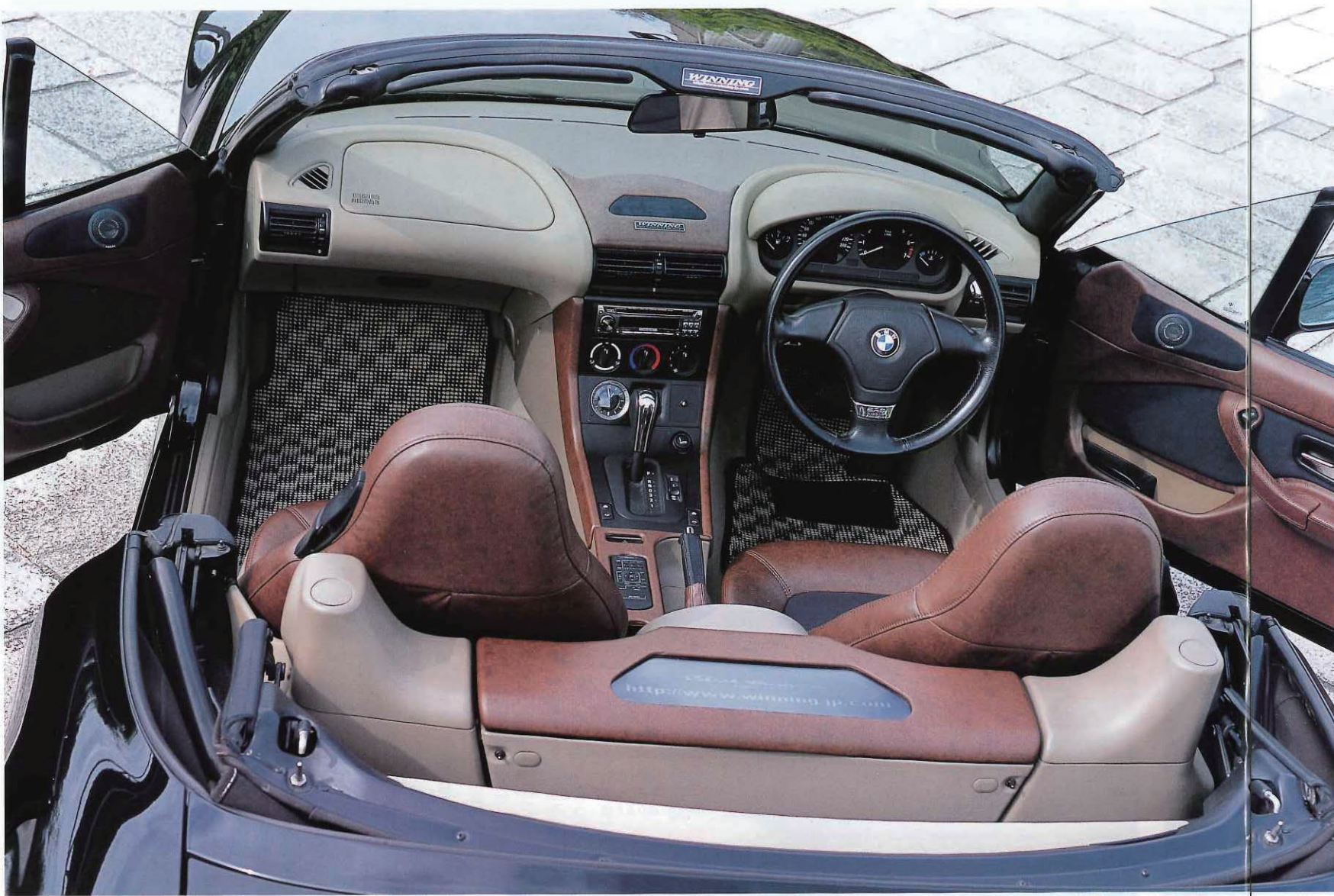
↑シートと同素材で張り替えたドア内張りだが、ポケット部にベージュの樹脂色を残しているのがミソ。フロアなどとの調和を考えた結果だ ↑後付けドリンクホルダーは絶対に嫌！とセンターコンソール部にワンオフで組み込む。同時にリモコン収納部も設けてスマートな空間に ↑この年式のZ3には時計がない。が、それを逆手に取ってエスカーレド用の純正パーツであるブルガリをインストール。女性ウケ良さそう
